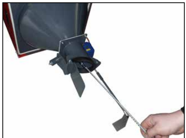
Bürsten des Siebs durch die Brennstoff-Ausschüttöffnung
