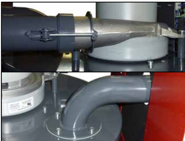
Anschluss der Ausblasleitung zum Lüfter ----- Anschluss der Saugleitung auf den Zyklon-behälter
