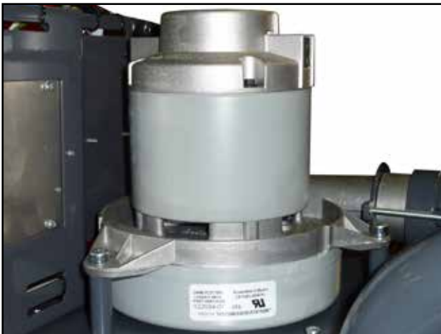
Motor des Sauglüfters der pneumatischen Förderanlage
