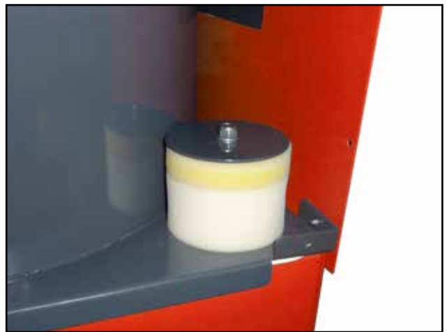
Schaumstofffilter auf den Austritt aus dem Pelletsvorratsbehälter
