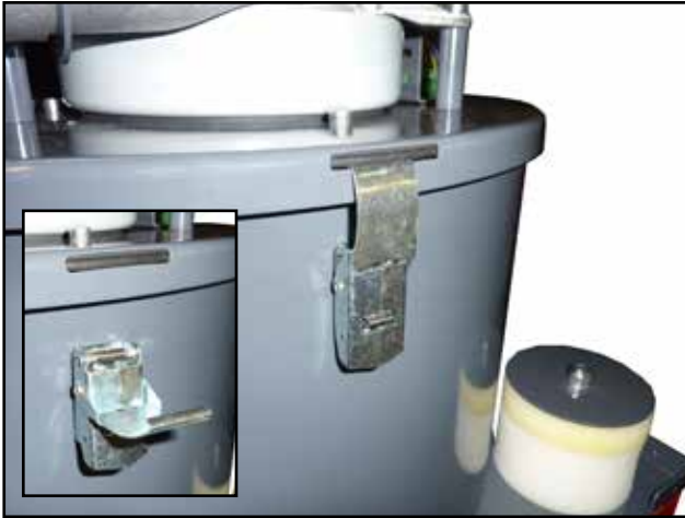
Deckelbefestigung des Abscheidebehälters
