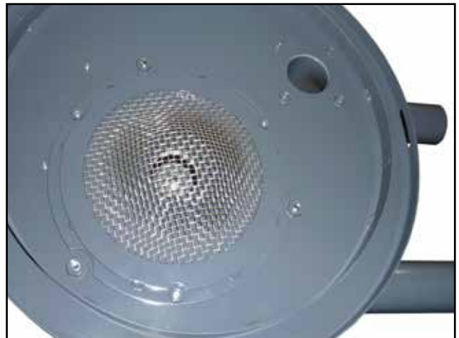
Detail des Siebs an der Öffnung unter dem Lüfter auf dem Motordeckel. Wir empfehlen das Sieb einmal jährlich zu überprüfen, bzw. zu reinigen. Die pneumatische Förderanlage muss dabei nicht demontiert werden, es genügt sie vom Behälter zu entfernen.
