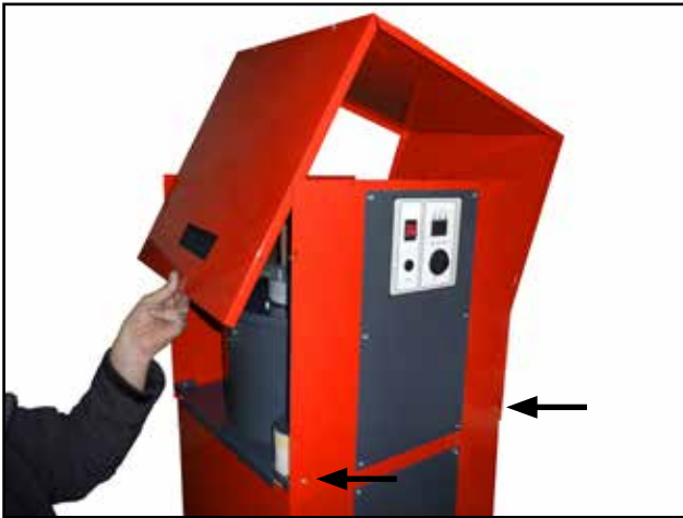
Bei der Kontrolle des Motors oder des Abscheidebehälters kann das mittlere Gehäuse entfernt werden
