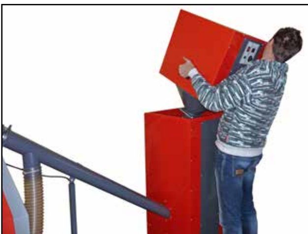
Abheben der pneumatischen Förderanlage vom Ausgleichbehälter
