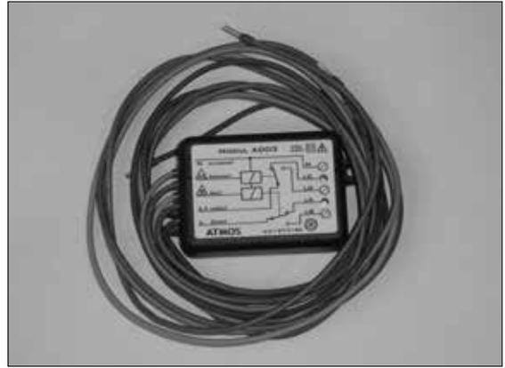
**Kode: P0436** für Ventilatorsteuerung und Ladepumpe im Kesselkreis (Solarpumpe)
